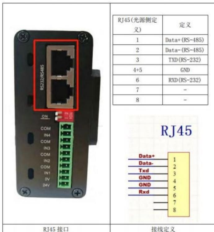
已知 N97F 的 485 模式在 COM2 串口上是 2,3 针脚输出，需要准备 RJ45 网线将水晶头插入数字光源控制器的 485 RJ45 接口，将另外一端的网线拆开，将橙白色的线与 2 连接，黄色的线与 3 连接
