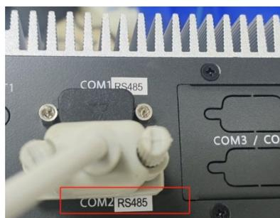
2、将 SY-DL4CH-CV-24-C-GL 光源控制器通讯模式设置成 485 模式，设置方法如下：
